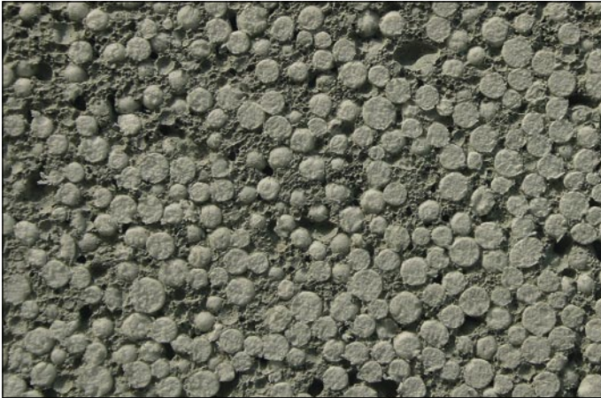
Struktura lahkega toplotno izolacijskega betona Politerm v prerezu
