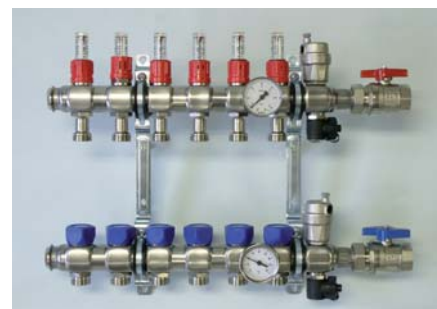
Razdelilnik za talno ogrevanje s šestimi priključki, opremljen z indikatorji pretoka, manometrom in termometrom in samodejnimi odzračevalnimi lončki.
