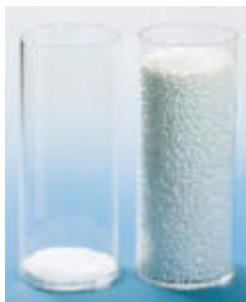
Slika 1 V epruveti na levi je surovina in na desni že penjen stiropor
