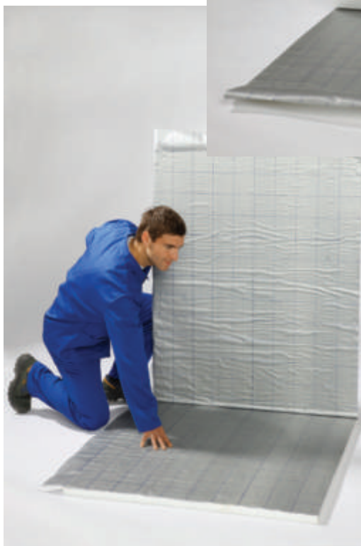
Slika 7 Stirotacker K spojeni plošči skupne površine 2,5 \text{ m}^2 , debeline 30 mm, uporaba za pode z večjo obremenitvijo (slika 086)
