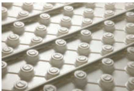
Slika 3 Termal PSF plošče iz trde polistirenske folije se položijo direktno na sloj toplotne in zvočne izolacije ali na drugo podlago
